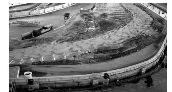
Abbildung 2: Physikalisches Modell der Oder bei Hohenwutzen in einer Versuchshalle der BAW (Quelle: BAW 20.08.2004)
