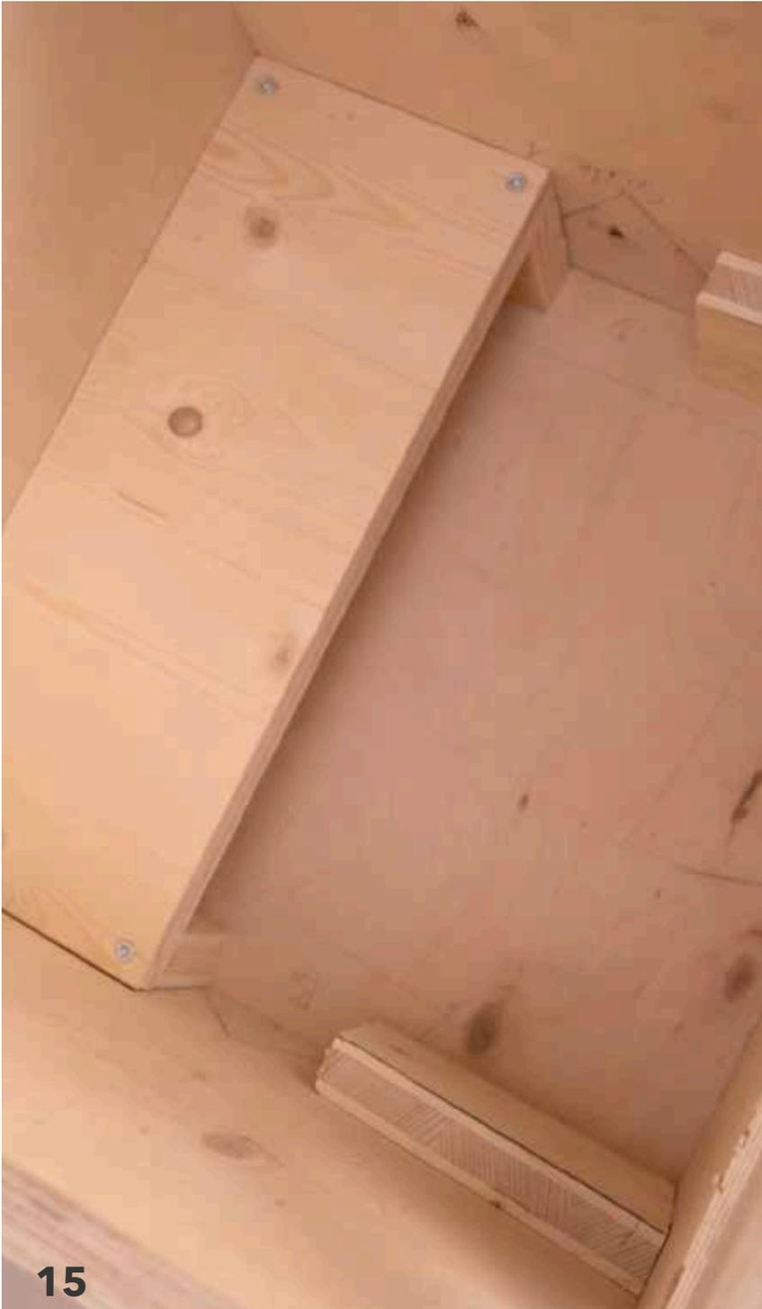
Die Monitorhalterung kann nun in der Kiste befestigt werden (z.B. mit Leim, doppeltes Klebeband oder kurze Schrauben/Nägel).
