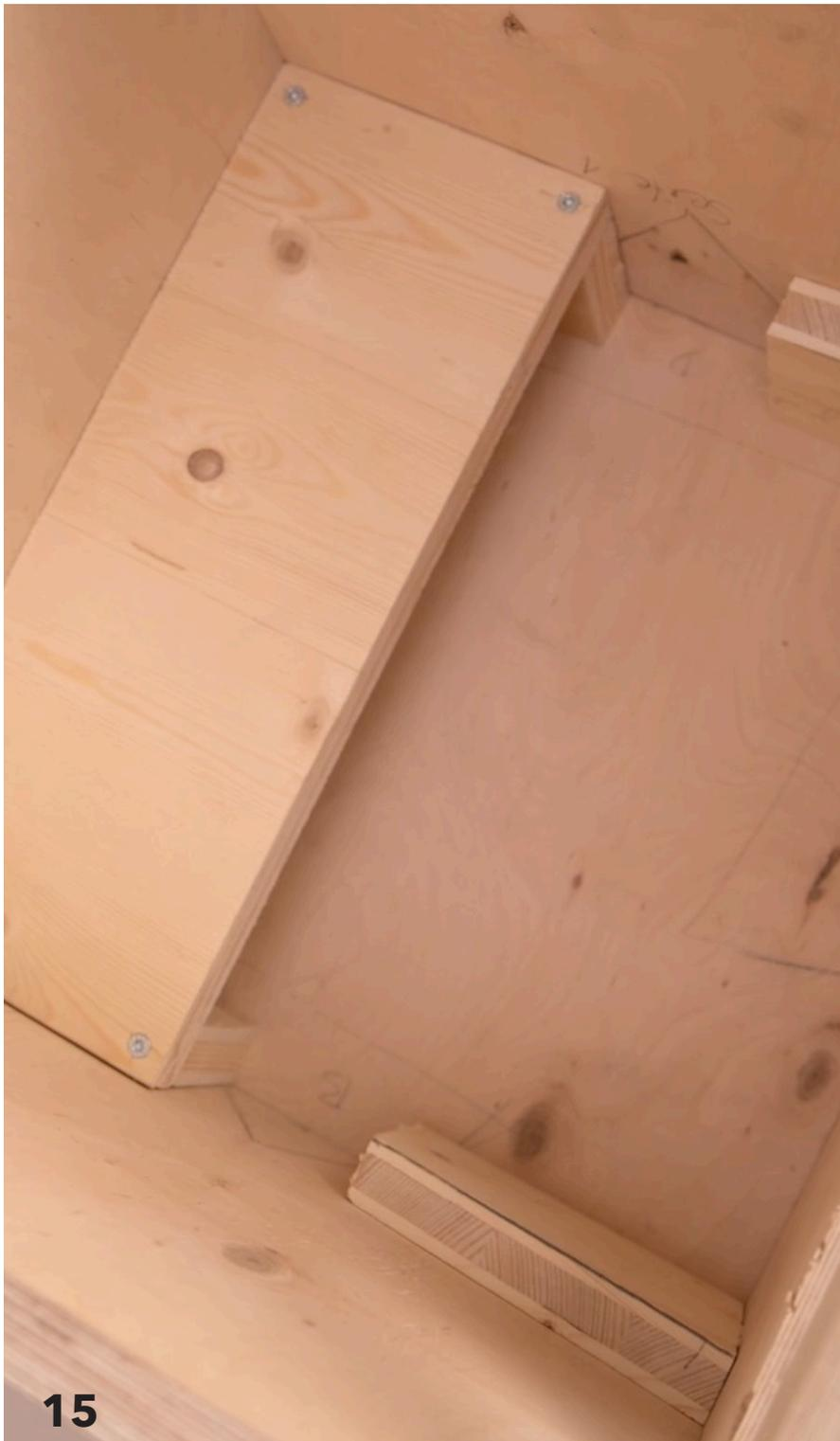
Die Monitorhalterung kann nun in der Kiste befestigt werden (z.B. mit Leim, doppeltes Klebeband oder kurze Schrauben/Nägeln).
