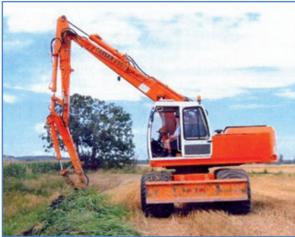
Bagger CAESAR mit 4m Mähkorb für die Sohl-, und Böschungsmahd
